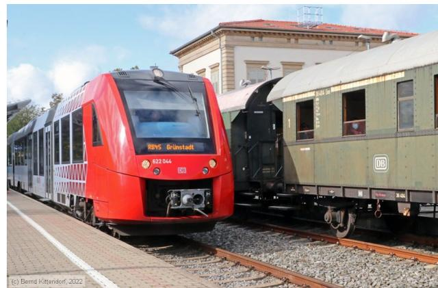
Abbildung 10: Diesel-Triebwagen 622 044 der DB (ein Alstom LINT 54 aus dem Jahr 2015) und der grüne Wagen 36 404 Esn (Gattung BCi-28, Hersteller Westwaggon, gebaut 1929) in Bad Dürkheim
