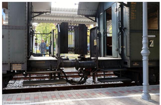
Abbildung 8: Stufen an zweiachsigen Wagen eines Sonderzuges im Bahnhof Bad Dürkheim. Einfach war das Einsteigen nicht mal bei der hier vorhandenen 38 cm Bahnsteighöhe.
