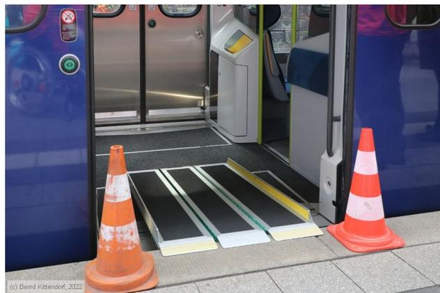
Abbildung 3: Einstiegsverhältnisse mit Faltrampe für Rollstühle in einen Coradia Polyvalent von CAF bei 76 cm Bahnsteighöhe
