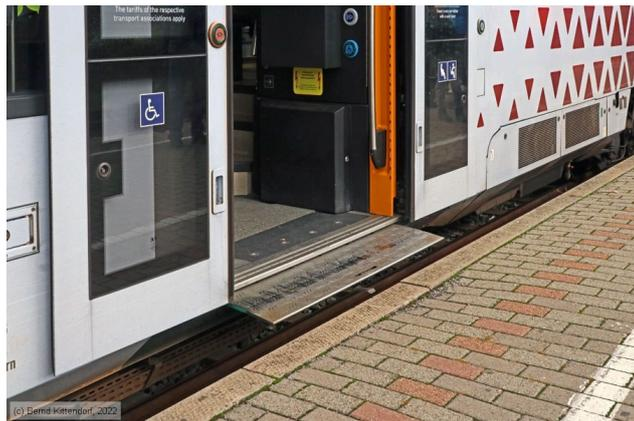
Abbildung 9: Ausgefahrener Schiebetritt des Triebwagens 622 044 im Bahnhof Bad Dürkheim an einem Bahnsteig mit 55 cm Höhe, besser als einst und doch noch „Luft“ am Spalt. Bei meiner Heimfahrt versagte der Schiebetritt und ich musste auf die Faltrampe für meinen Rollstuhl warten.
